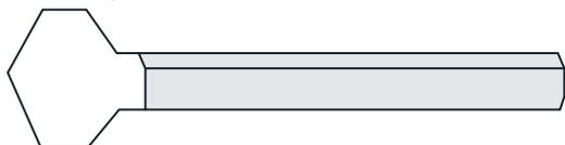
Рис. 2.7.3. Сверло для устройства трубных разводок в стенах
